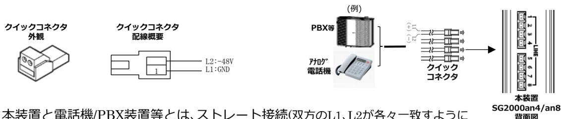
本装置と電話機/PBX装置等とは、ストレート接続(双方のL1、L2が各々一致するように接続)する必要があります。クイックコネクタに付替える際には、十分に注意願います。
