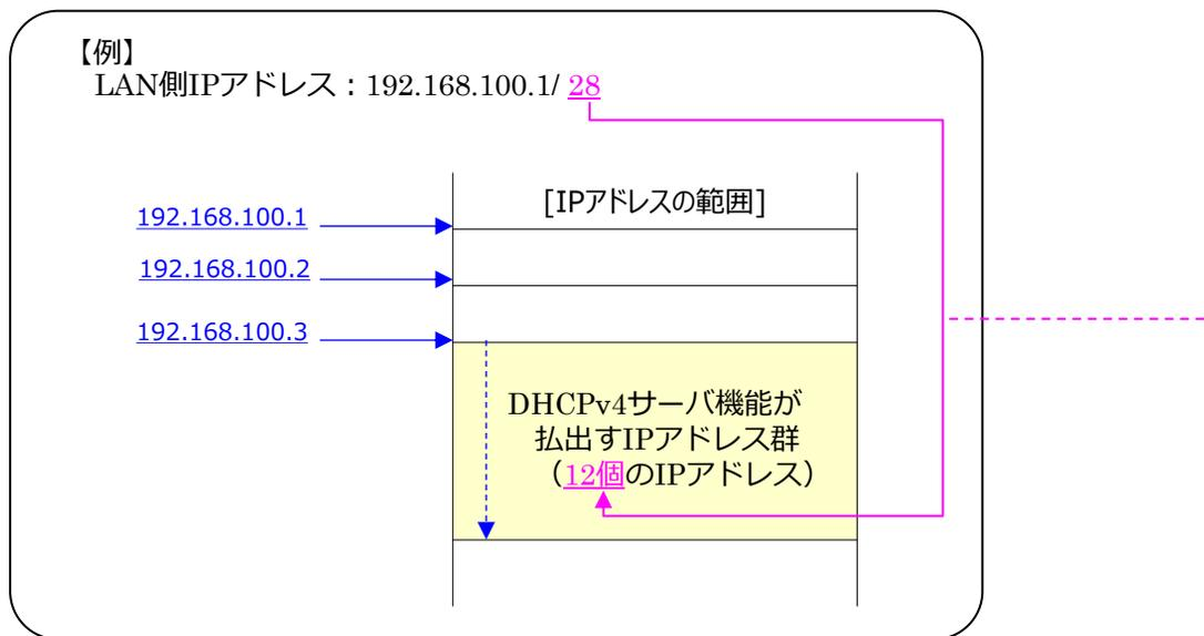
①本装置では、「LAN側IPアドレス」として設定された1個のIPアドレス以外に、もう1個のIPアドレス(=内部処理用IPアドレス)が必要となります。この内部処理用IPアドレスは、「LAN側IPアドレス」の4オクテット目の数値に「1」を足したものとなり、上記例の場合では、内部処理用IPアドレスは、[192.168.100.2]となります。
