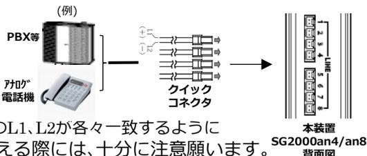
本装置と電話機/PBX装置等は、ストレート接続(双方のL1、L2が各々一致するように接続)する必要があります。クイックコネクタに付替える際には、十分に注意願います。
