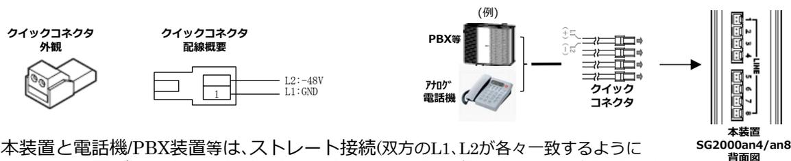
本装置と電話機/PBX装置等は、ストレート接続(双方のL1、L2が各々一致するように接続)する必要があります。クイックコネクタに付替える際には、十分に注意願います。
