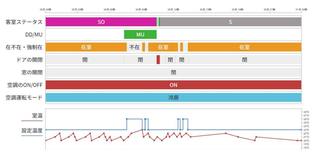
「Smart All in」では客室ステータスをはじめ、客室の在/不在、DD/MUR、空調情報、ドアの開閉情報等の他システムとの連携情報を、トレンドグラフとして客室単位で表示することができる。システム毎に連携されたリアルタイム情報を時間経過軸に表示し、常に客室内の状態を可視化することで、ゲストサービス向上並びにオペレーションマネジメントに運用可能だ。
