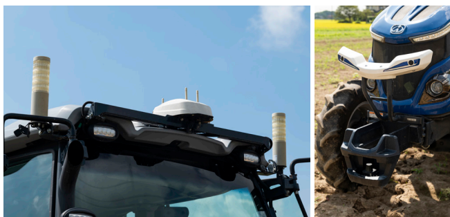
屋根の上の中央がGNSSアンテナ。左右に運行状況を知らせる信号灯、前後左右に衝突防止のセンサーが備わっています。
