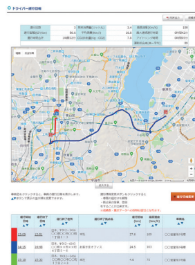
1日の走行経路を含めた詳細な運行データを記録、表示。日報を自動生成してPDF、CSVデータに出力できる
