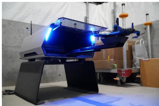
実証実験に使用したドローンポート「Skydio Dock」
