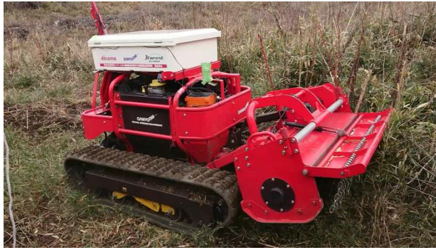
<通信システムを活用した下刈り作業機械の遠隔操作化>
