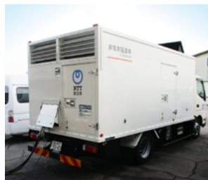
【NTT西日本非常用電源車】
