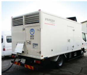
【NTT西日本非常用電源車】
