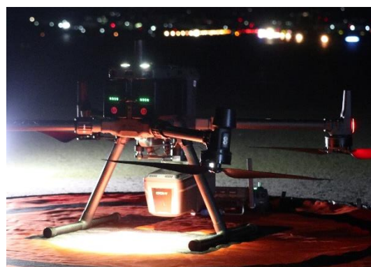
＜路面状況の点検に用いたレーザ計測機＞
