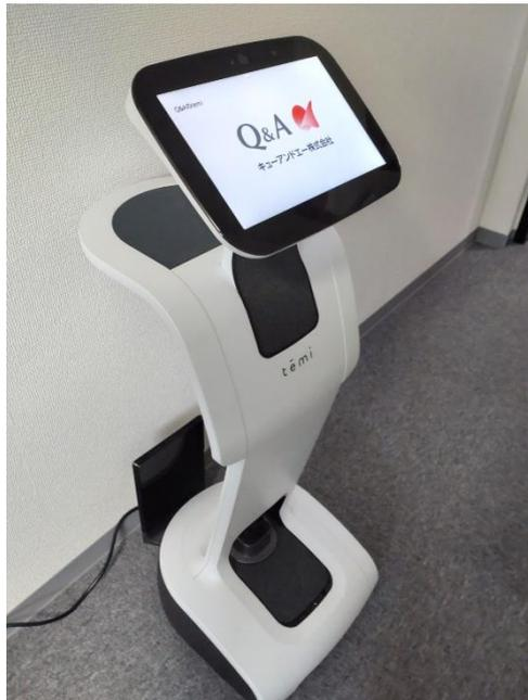
「temi」は、遠隔操作により自立走行する AI を搭載したロボットです。仙台の拠点にいる管理者がタブレットを操作すると、南三陸のコールセンターにいる「temi」が、オペレーターのいる居室を巡回します。「temi」を通じてオペレーターの映像がタブレットに送られ、管理者が現地にいるかのように様子を把握できます。管理者は、ビデオ通話機能を使ってオペレーターに声をかけたり、応対後にアドバイスを رفتたりすることが可能です。
