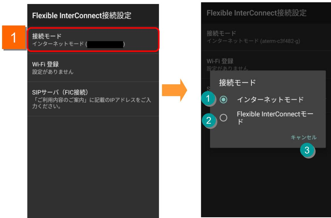
1 Flexible InterConnect接続設定の[接続モード]をタップすると、接続モードの設定画面が表示されます。
