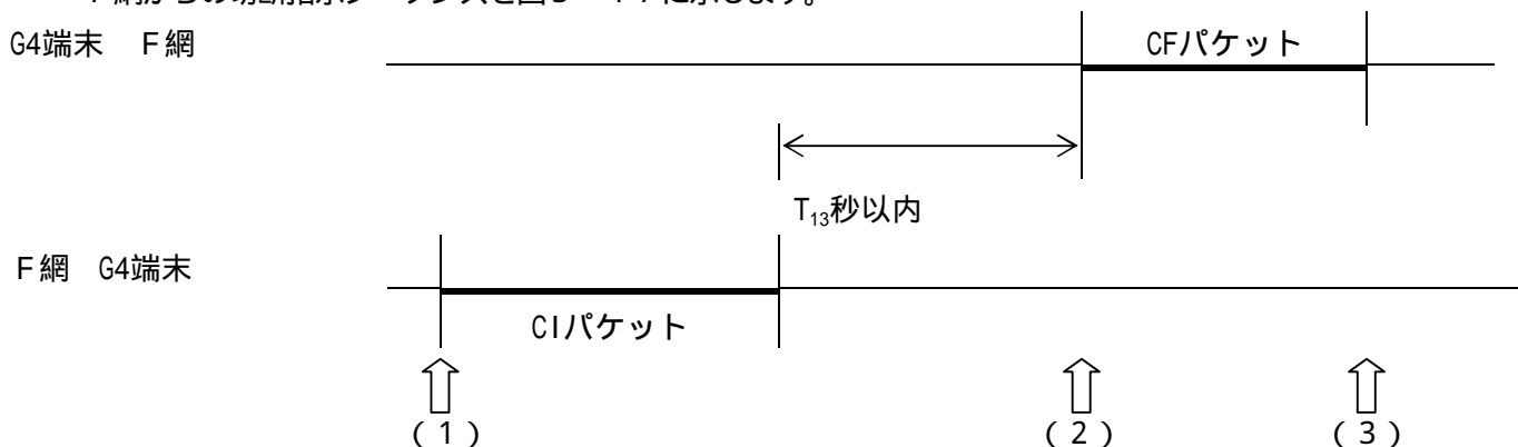
図3-17 切断指示時のシーケンス
