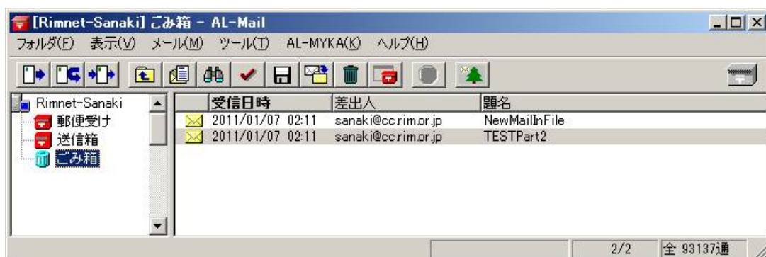
図 2.5-2: 図 2.5-1 の結果。二通のメールを受信したことから、SMTP Command Injection が成功してしまったことが分かる
