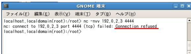
図 2.2-14 : 図 2.2-13 の後にもう一つのシェルで 4444/tcp に接続することはできない
