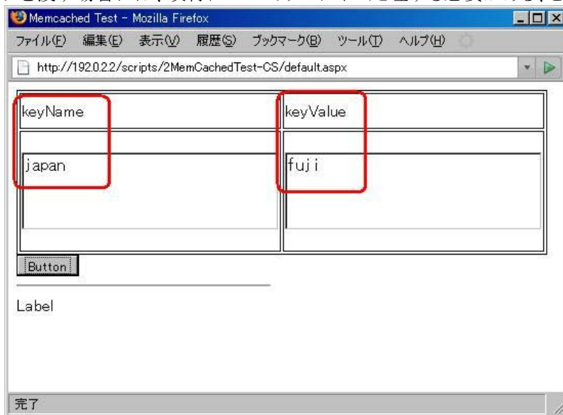
図 4.5-2 : 図 4.5-1 を使って、データ書き込みを行い、正常動作を確認した
