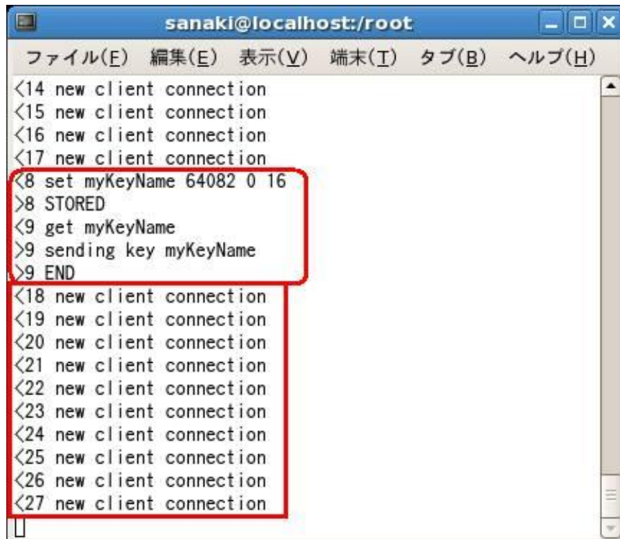
図 4.4-9 : 図 4.4-7 の結果 2。No9 までは図 4.4-6 と同じであるが、それ以降はそもそも書き込み/読み出しの通信が発生していないことが確認できる
