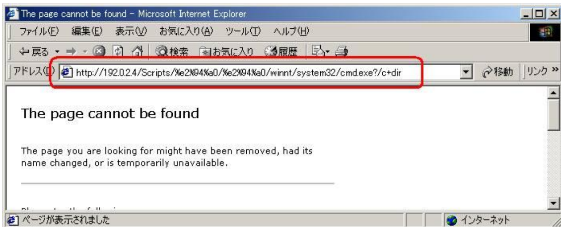
図 3.5-7 : 「U+2025」をリトルエンディアンとして「0x2520」として仮定し、3Byte の UTF-8 表現である「%E2%94%A0」でアクセスしたが、MS00-057 が再現しない
