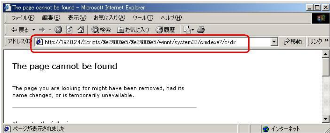
図 3.5-6 : 「U+2025」をそのまま「0x2025」と仮定し、3Byte の UTF-8 表現である「%E2%80%A5」でアクセスしたが、MS00-057 が再現しない
