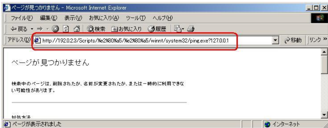
図 3.5-2 : 「U+2025」をそのまま「0x2025」と仮定し、3Byte の UTF-8 表現である「%E2%80%A5」でアクセスしたが、MS00-057 が再現しない
