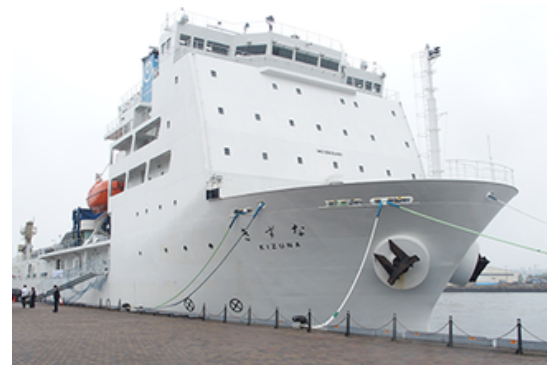
2017年3月31日に就航した新しいケーブル敷設船である「きずな」。大地震などにおける迅速な通信復旧に活用できる、災害対応機能を付加した初めてのケーブル敷設船となる。
